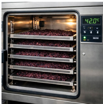
Рисунок 1 - Камера низкотемпературной сушки (40–50°C)
