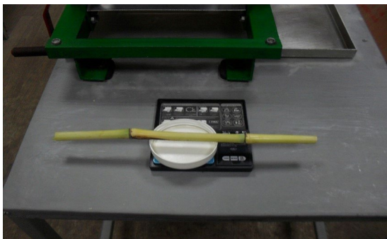
Рисунок 1 – Взвешивание стебля до прокатки через пресс
